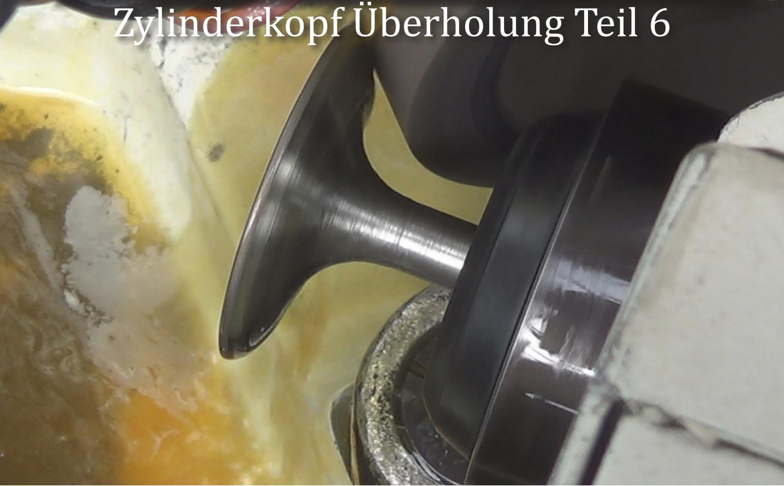
Die Kontaktflächen der Ventile können bei gebrauchten Ventilen durchaus leichte Abnutzungsspuren aufweisen, z.B. leichte Fress-Spuren durch entstandene Korrosion oder Einbrand. Daher müssen auch die Ventile leicht angeschliffen werden, um später einen perfekten Kontakt mit dem Ventilsitz zu haben. Das Ventil wird in eine rotierende Spann-Halterung eingespannt und in dem Winkel der Ventilsitzkontaktfläche an einen gegenläufig rotierenden Schleifstein herangeführt.
